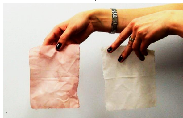
Рис. 5. Испытание чистящих свойств ЩИВ на примере очистки салфетки от красного вина: после первого смачивания (а), после 10 сек. смачивания (б), результат очистки (в)
