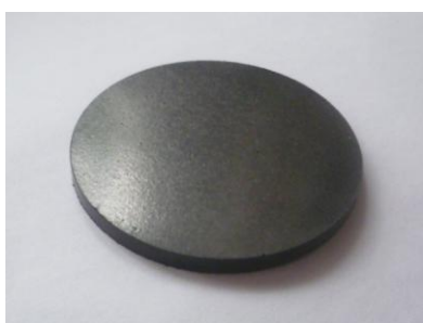
Рис. 1. Алмазно-абразивный инструмент на основе теплопроводного полимерного Композита
