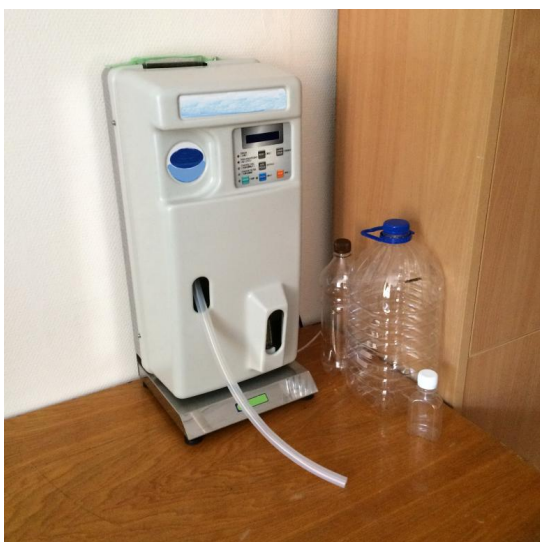
Рис. 1. Опытно-лабораторная установка производства NSIW с рН, равным 12,5 \pm 0,3
