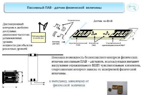
Рис. 3. Пассивные ПАВ - датчики
