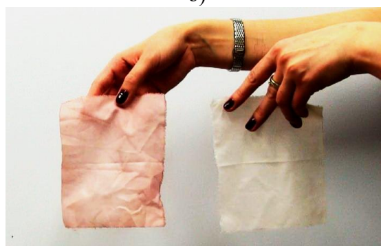
Рис. 17. Испытание чистящих свойств ЩИВ на примере очистки салфетки от красного вина, после первого смачивания (а), после 10 сек. смачивания (б), результат очистки (в)
