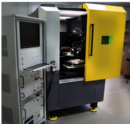
Рис. 9. Российская установка для резки приборных пластин на кристаллы МЛП1-1060/355
