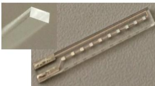
Рис. 7. Резка узких сапфировых подложек (а) для светодиодных ламп нового поколения (б)
