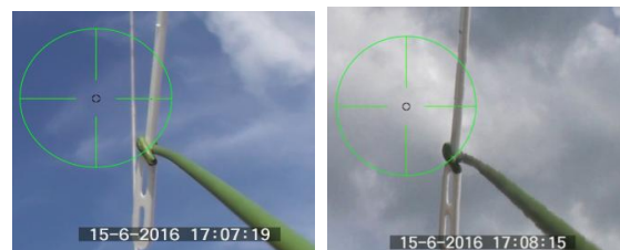
Рис.1. Фото облачности с видеокамеры, полученные при направлении 4 ( \alpha_{\text{зонд}}=120^\circ ) и при направлении 6 ( \alpha_{\text{зонд}}=180^\circ ). В поле зрения видеокамеры отмечены диаграммы направленности РЛС – (центральный кружок) и диаграммы радиометра (большой круг).
