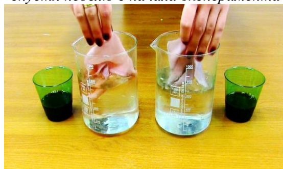
Рис. 16. Испытание стальной пластины на коррозию в обычной воде и в ЩИВ спустя неделю с начала эксперимента
