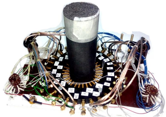
Рис. 5 - Фотография образца с установленными электродами
