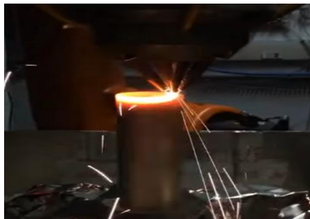
Рис.3. Процесс наплавления металла лазерным экструдером
