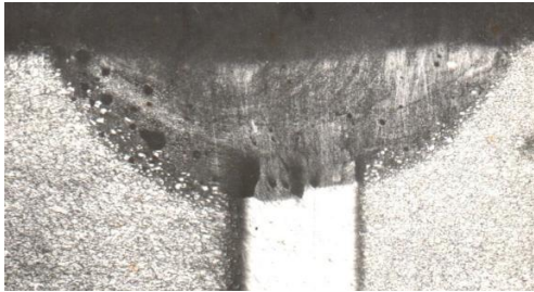
Рис.2. Сварное соединение сплава САС-1 с прослойкой из технического алюминия
