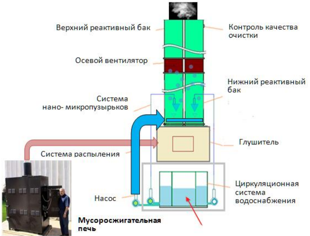
Рис. 13. Структурная схема процесса очистки дымовых газов мусоросжигательной печи с помощью nano-микропузырьков NSIW
