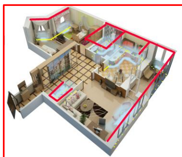
Рис. 3. Схема прокладки гибридного кабеля в виде потолочного контура защиты от затоплений помещений с верхних этажей.
