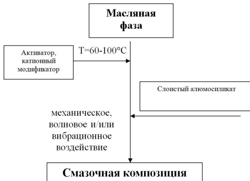
Рис. 1. Схема приготовления катионной смазки путем in situ модификации в процессе механического диспергирования
