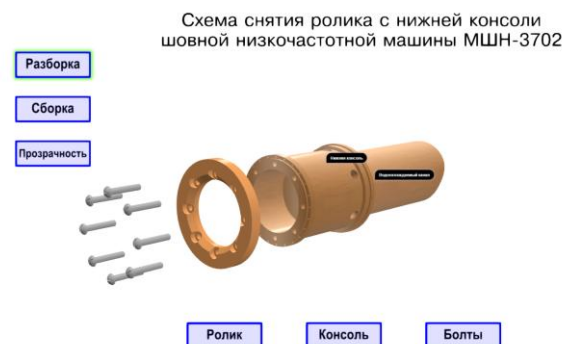
Рисунок 1. Оформленная геометрическая модель нижней консоли шовной низкочастотной машины типа МШН – 3702
